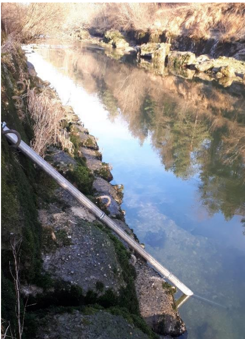
Image 1 : Installation d'une sonde dans la Sarine en aval du barrage du lac de Schiffenen permettant la récolte de données
